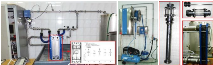
Rys. 7. Stacja mycia CIP i mycia pianowego
